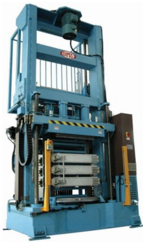
Bild 5: Eine schruppflose Aufweitungsanlage von Zhongshan OMS Industrial wird für die Produktion von Wärmeübertragern mit kleineren Kupferrohrdurchmessern für Klimageräte im Wohnbereich verwendet.
